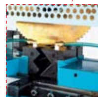
Воздушный обдув внутри губок тисков для лучшего удаления стружки
