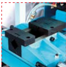
Самоцентрирующаяся каретка подачи трубы (или пакета труб)
