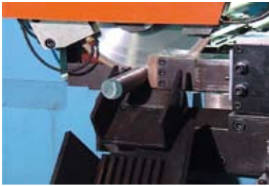
Высокопроизводительная резка заготовок из проката или труб. Автоматический сепаратор готовых изделий на выходе
