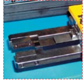
Зажимные клещи с гидравлическим приводом позволяют пробивать заготовку
