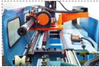
Каретка подачи имеет специальную «свешенную» конструкцию
