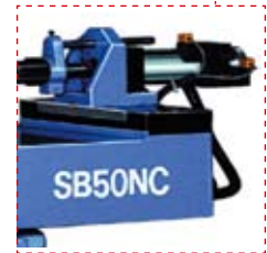
Автоматическая система подачи и возврата (2 скорости) дорна в исходное положение
