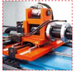
Автоматизированная каретка для фиксации подачи и поворота трубы в пространстве
