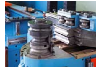
Многоголовочная конструкция с прямой пирамидой (внизу – большой радиус гибки, сверху – малый)
