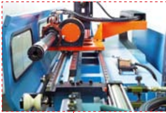
Картка подачи имеет специальную «свешенную» конструкцию
