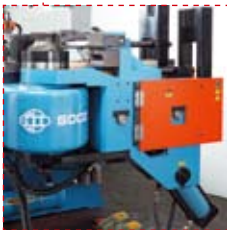
Гибочная консоль с функцией понижения скорости перед окончаниемгиба
