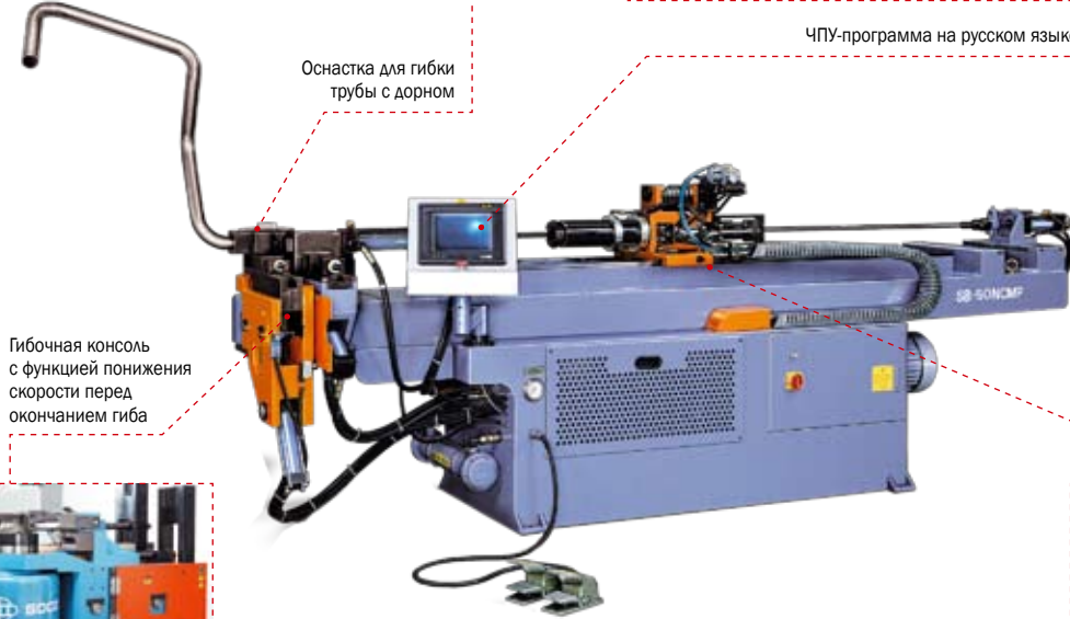
Автоматизированная каретка для фиксации подачи и поворота трубы в пространстве
