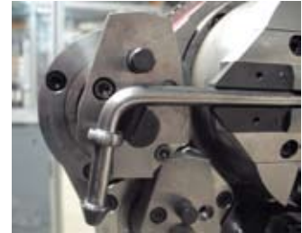
Автоматический процесс: обработка -> гибка -> резка заготовки. Быстрое и безотходное производство
