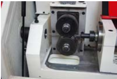
Пневматический прижим подающих роликов с регулировкой давления
