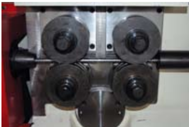
Гидравлический прижим подающих роликов с регулировкой давления
