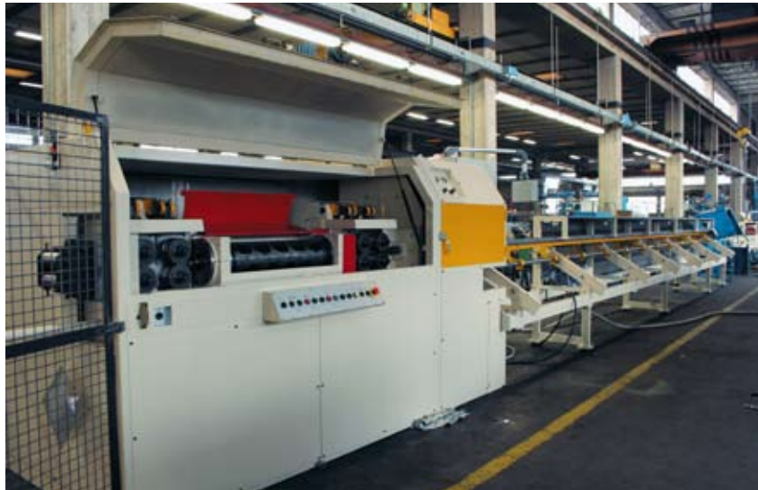
Гидравлический прижим подающих роликов с регулировкой давления
