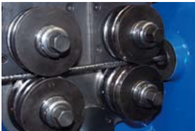
Гидравлический прижим подающих роликов с регулировкой давления
